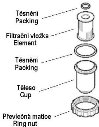
Топливный сепаратор воды содержит элемент фильтра, который должен быть заменен в соответствии с Инструкцией (см. ДИАГРАММУ ОБСЛУЖИВАНИЯ/ОБСЛУЖИВАНИЯ).
