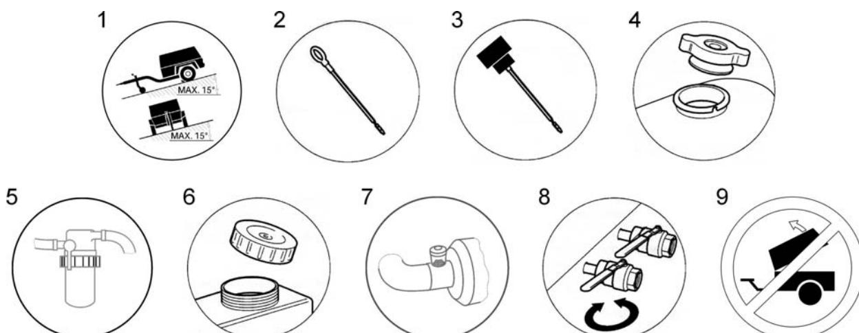
1. Установите компрессор горизонтально (максимальный допустимый наклон по его продольным и поперечным осям - 15°) и закрепите его, используйте подставки.
